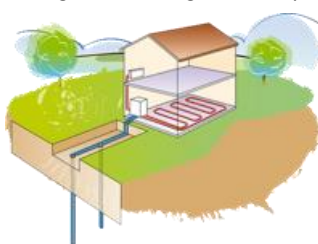
Forage sur sonde géothermique
